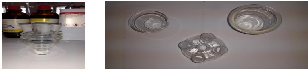
Photo 1: cellule de voltamétrie cyclique à 3 électrodes (avant montage)
