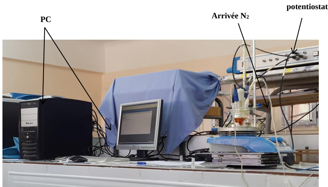
Photo 5) Equipements électrochimie utilisés dans le travail
