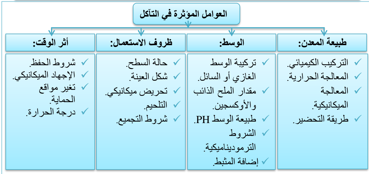
الشكل (3.IV): مخطط يوضح العوامل المؤثرة في التآكل.
