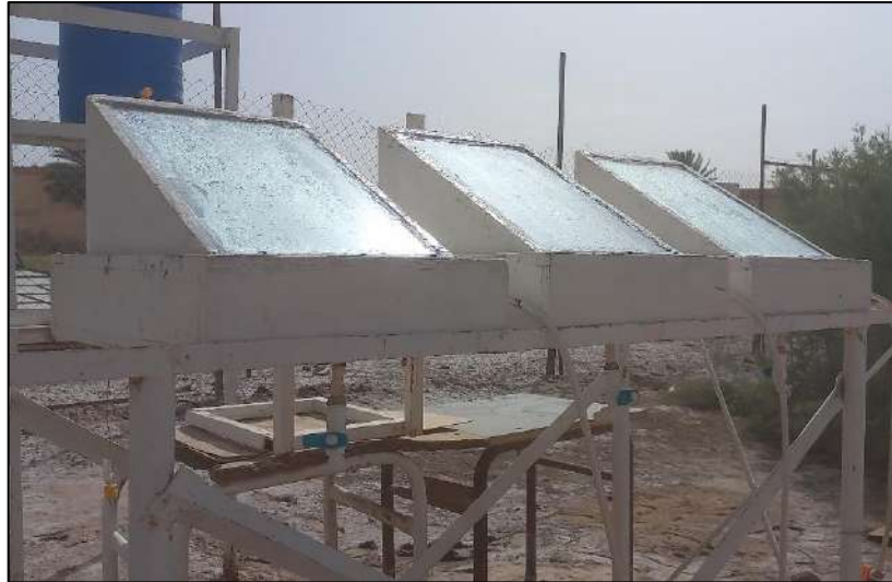
Figure III.1 : Conception du distillateur solaire utilisé dans les expériences.
