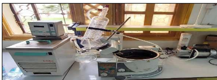
Figure 12 : Récupération du solvant
