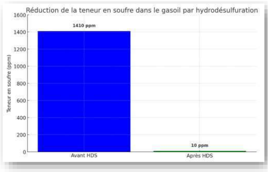
Figure IV.9 : illustration graphique de la réduction de la teneur en soufre dans le gasoil par hydrodésulfuration
