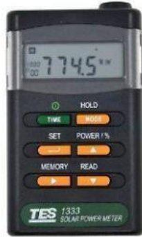
شكل 3-6 يمثل جهاز قياس شدة الاشعاع الشمسي (solarometer)
