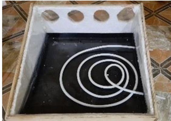
شكل 2-3 يوضح تسهيل عملية التبادل الحراري للماء داخل وخارج المضخة
