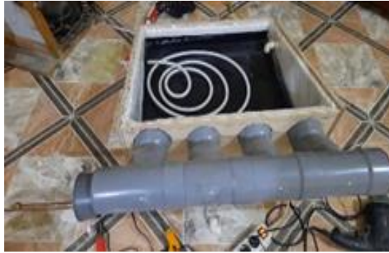
شكل 3-3 يوضح زيادة مساحة التبادل الحراري بين بخار الماء و المضخة الحرارية.
