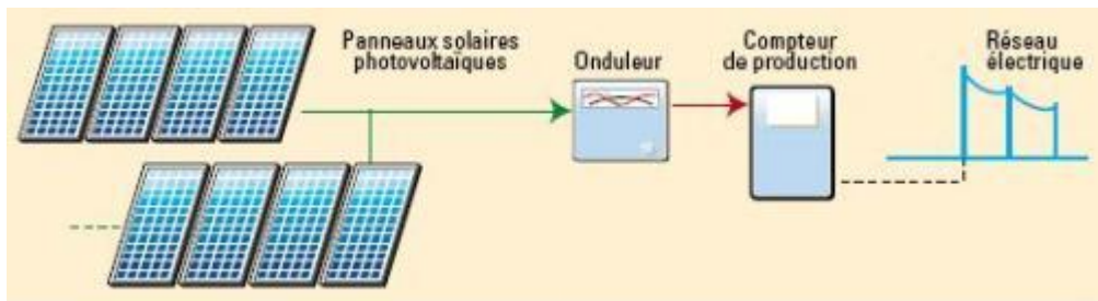
Figure 11 : Structure d'un système PV connecté au réseau.
