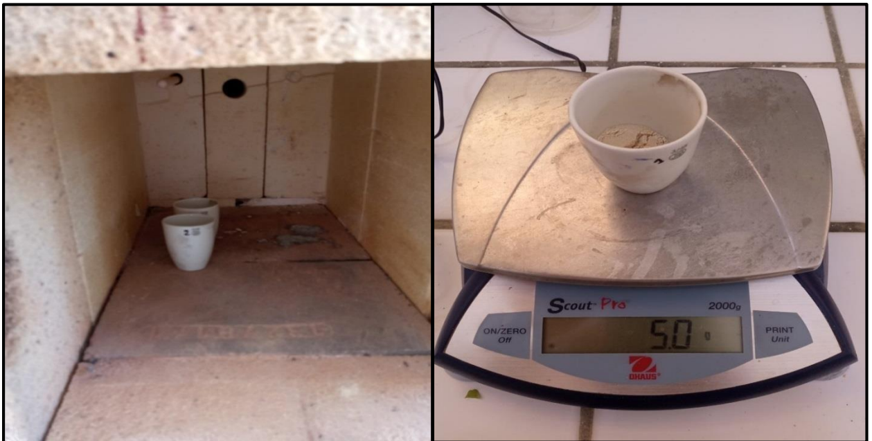
Figure III.10 : détermination le taux de cendre par four à moufle.
