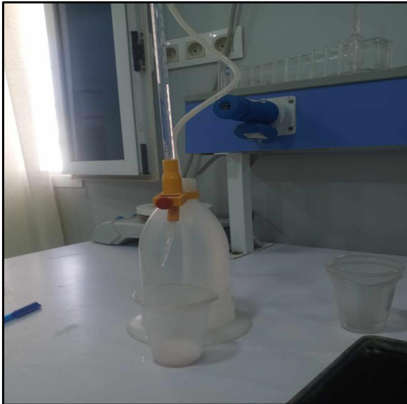
Figure III.14 : mesure l'acidité titrable de yaourt
