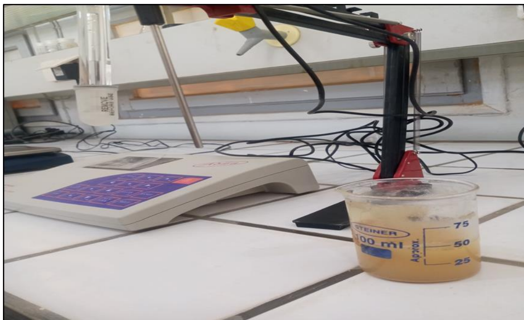
Figure III.9 : détermination le pH de quinoa par pH mètre.
