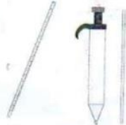
Pipette graduée de 1 mL ou pipette paille avec piston 1 mL ou 0,1 mL.
