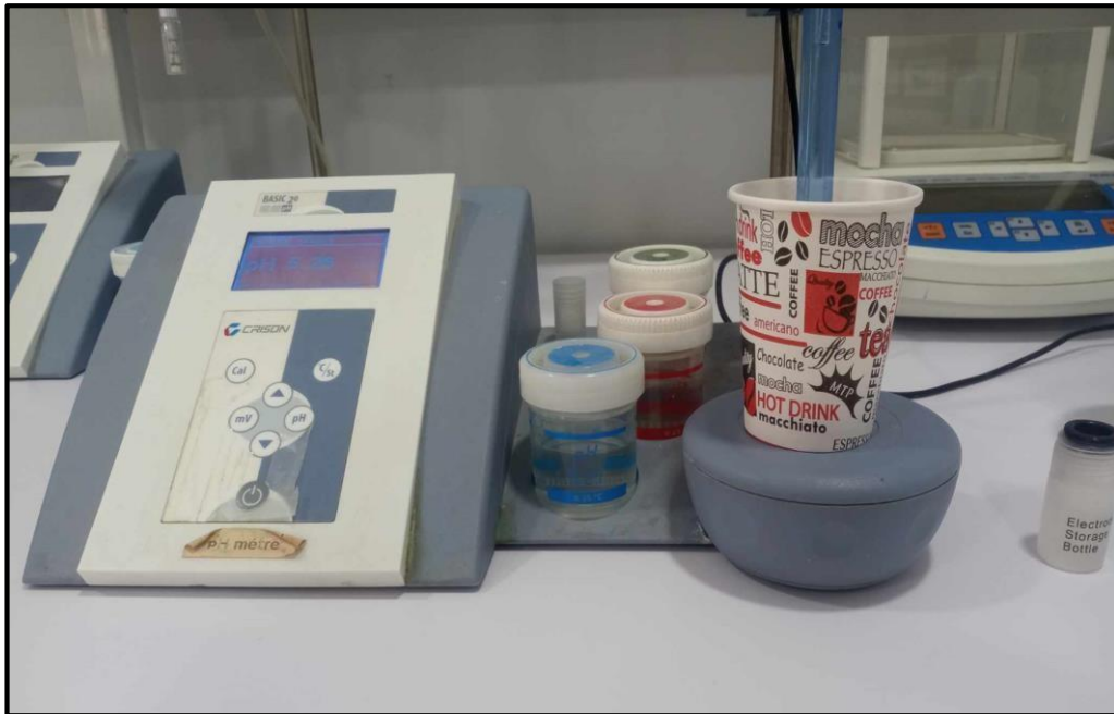
Figure III.13 : détermination le pH de yaourt par pH mètre.
