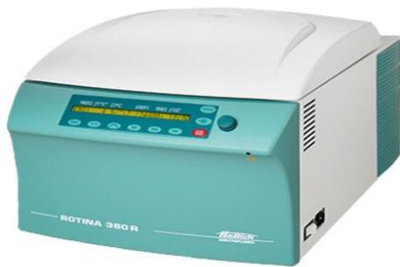
Centrifugeuse électrique( rotina 380 p zentrifugen hettich).
