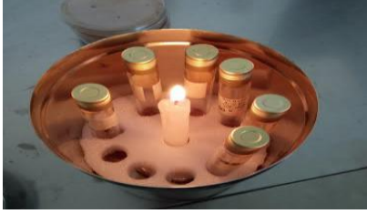
Jarre d'anaérobiose utilisée pour la culture des bactéries lactiques.
