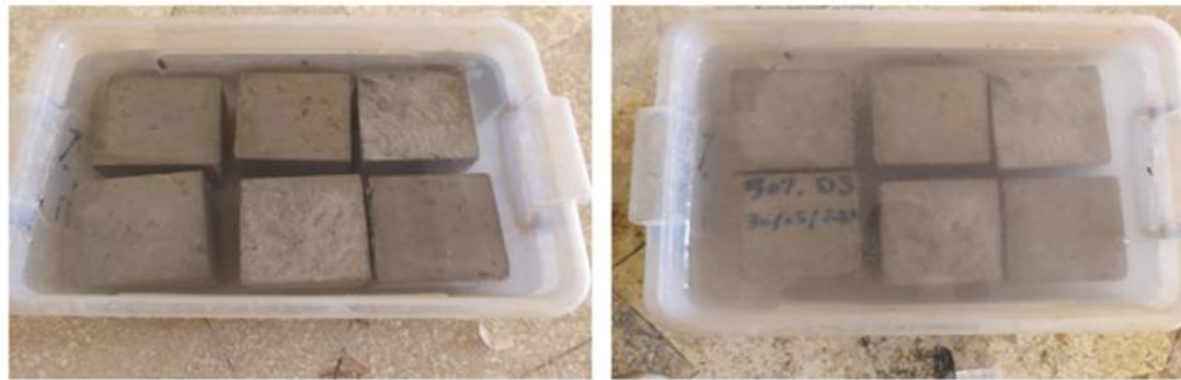
Figure 4.14: Les éprouvettes immergées dans la solution sulfate ( \text{Na}_2\text{SO}_4 ).
