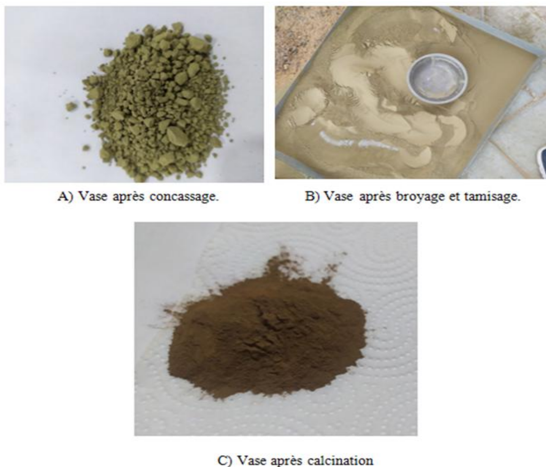
Figure 4.4: Étapes de préparation des sédiments de dragages (Vase).
