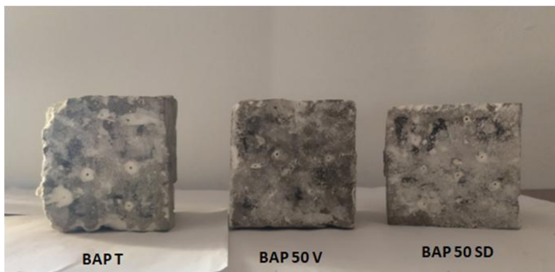
Figure 5.14: Contrôle visuel d'échantillons immergés pendant 200 jours dans une solution à 5% de sulfate de sodium ( \text{Na}_2\text{SO}_4 ).
