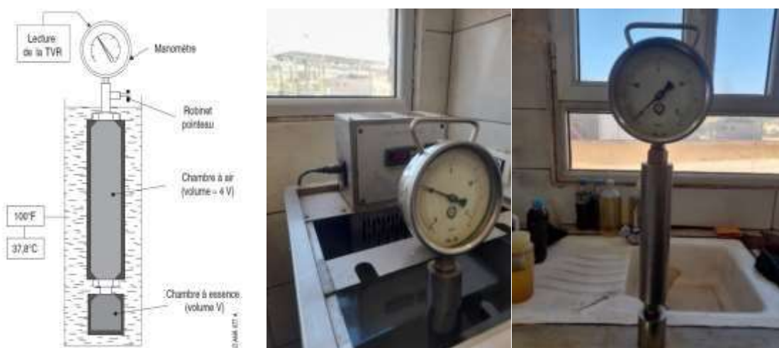
Figure III.18 : L'appareil de test de TVR .
