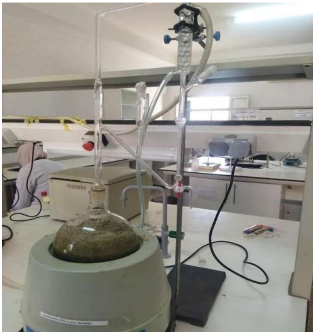
Figure II.2: Photo du montage d'hydrodistillation (Clevenger)
