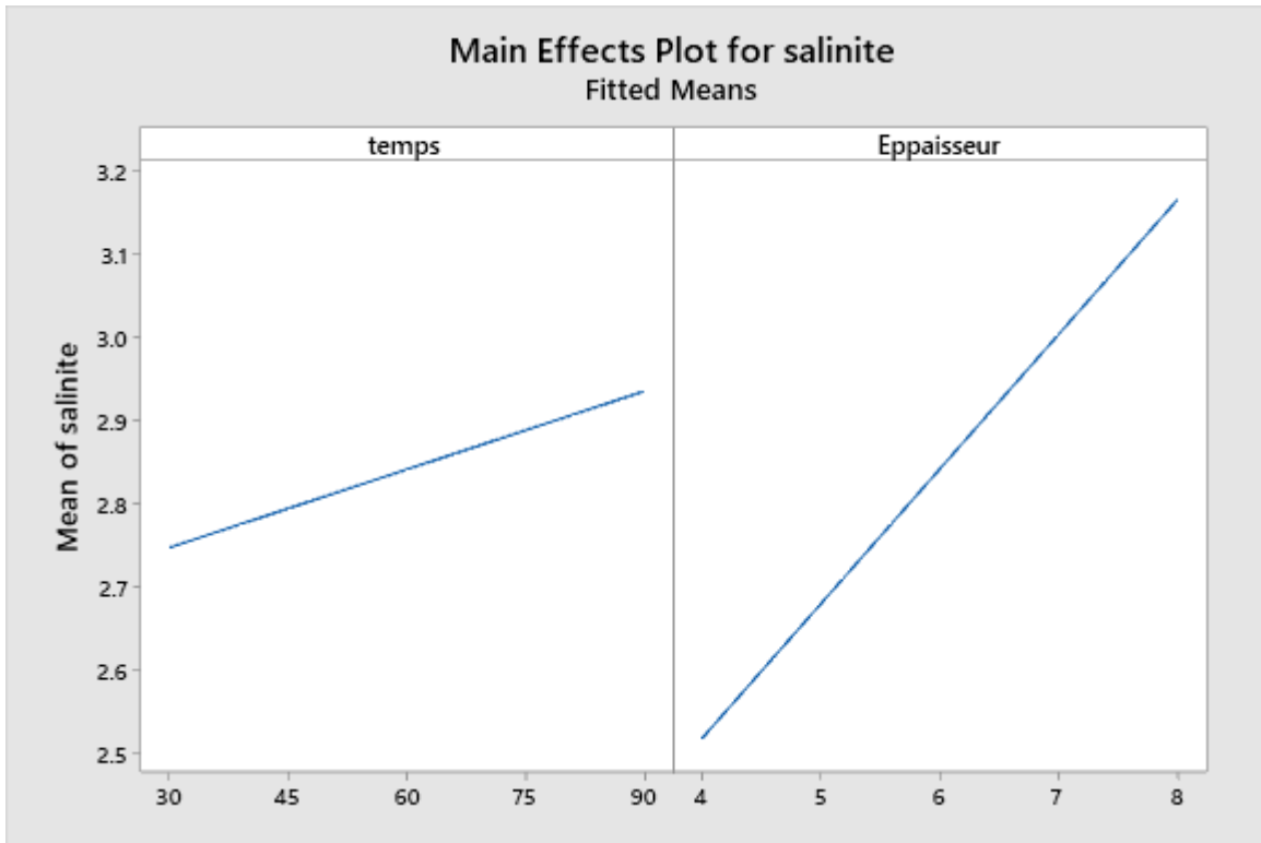
Figure III.69. Effet du temps et de l'épaisseur sur la salinité des tranches de viande.
