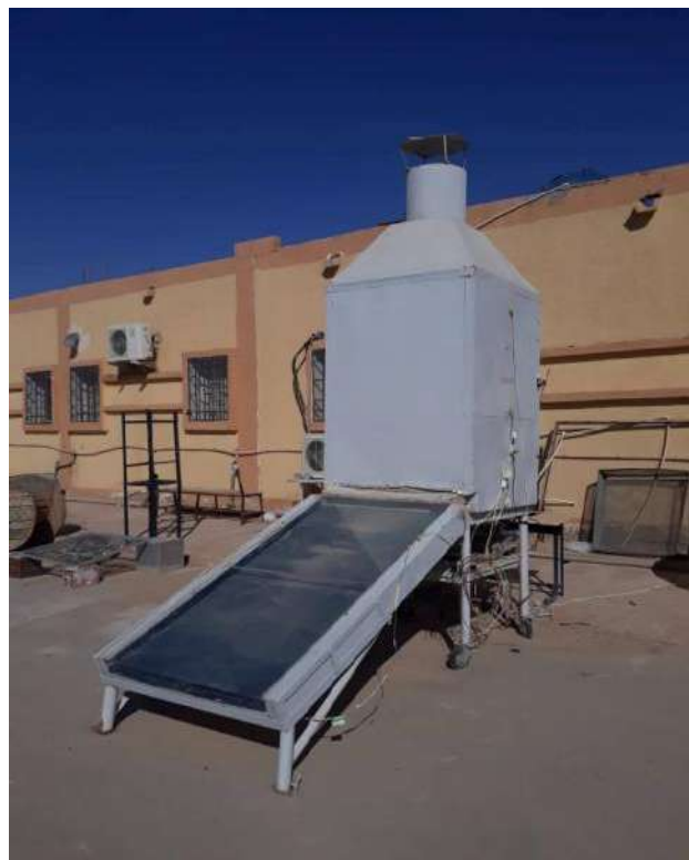
Figure .4. Photographie du séchoir solaire indirect [29]
