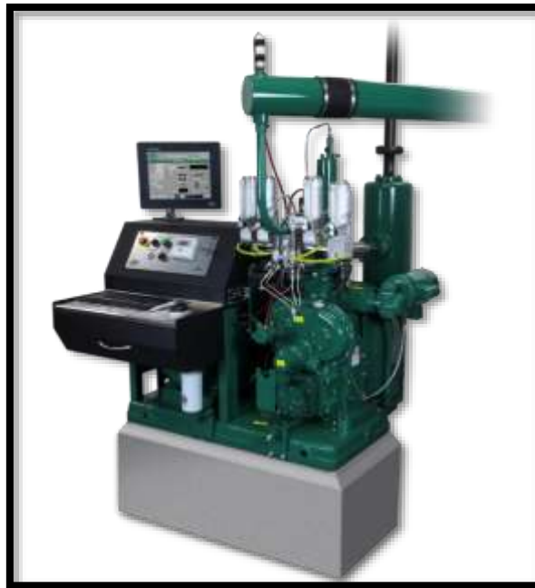
Figure II-6: Le moteur à indice d'octane CFR spécifie l'équipement pour tester les carburants.
