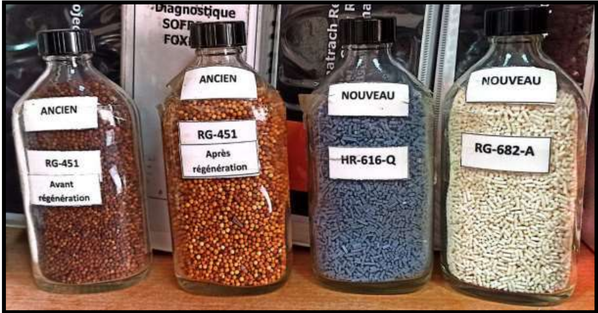
Figure 0-8: les nouveaux et l'anciens catalyseurs d'hydrotraitement et de reforming catalytique (HG-682 \ HR-616).
