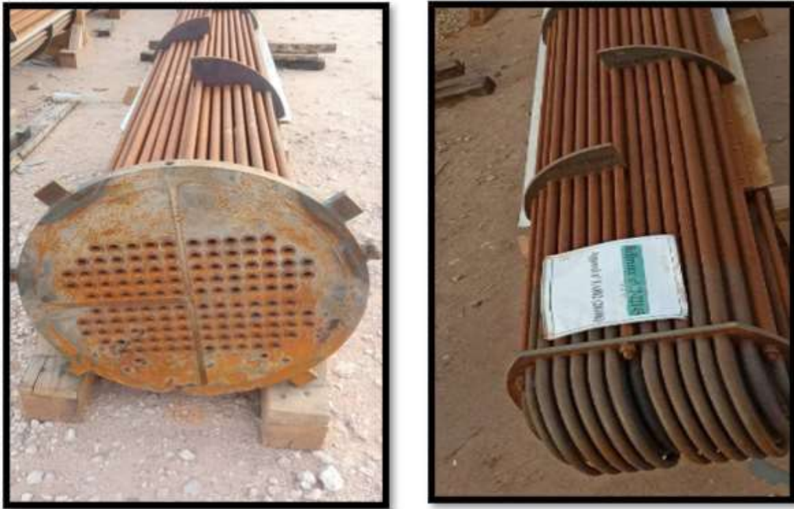
Figure III-11: photo réelle d'échangeurs de l'unité de reforming catalytique ou niveaux de l'RHM2.
