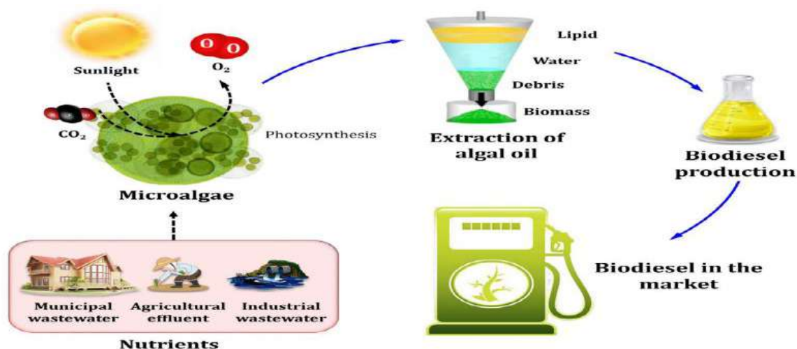
Figure III-7: Biodiesel à partir de biomasse de microalgues[4]
