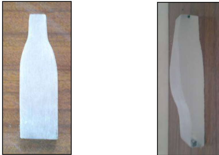
Fig. 4.28 : Profile du guide de lumière monolithique torsadé après modelage
