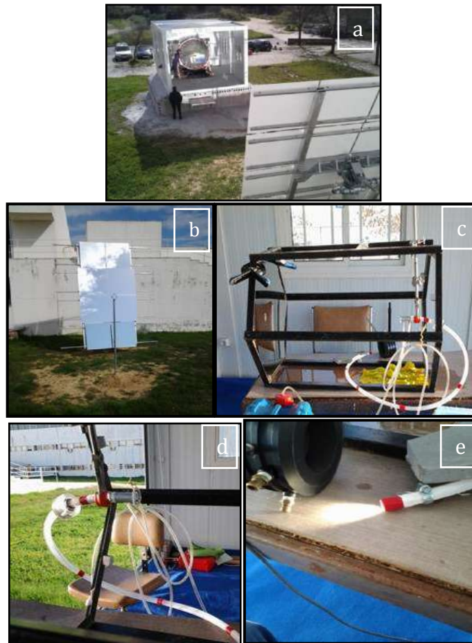
Fig. 4.12 : Aspect général du système de transmission de la lumière solaire par fibres optiques (a) Aspect général du système de concentration de la lumière solaire, (b) Réflecteur solaire, (c) Concentrateur parabolique, (d) Fibres optiques placées au plan focal, (e) Lumière solaire four- nie par le système.
