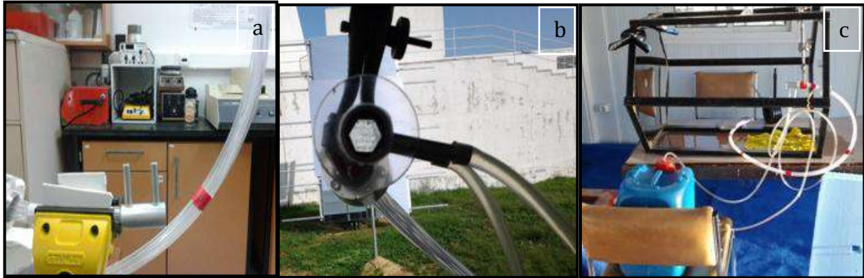
Fig. 4.14 : Système de refroidissement, (a et b) Trous et tubes d'injection et d'évacuation d'eau, (c) Réservoir avec le système de pompe
