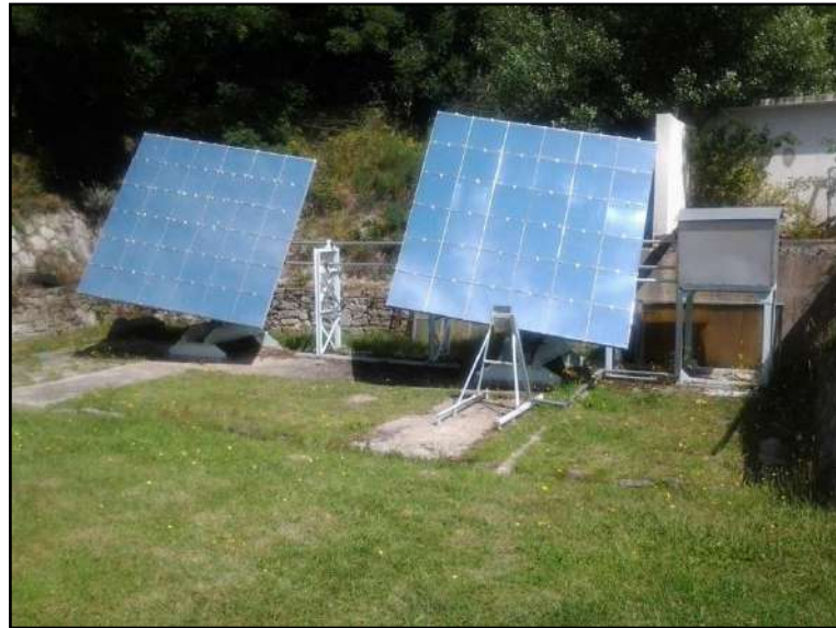
Fig. 4.34 : Système de collection de la lumière solaire monté sur un système de poursuite solaire à deux axes
