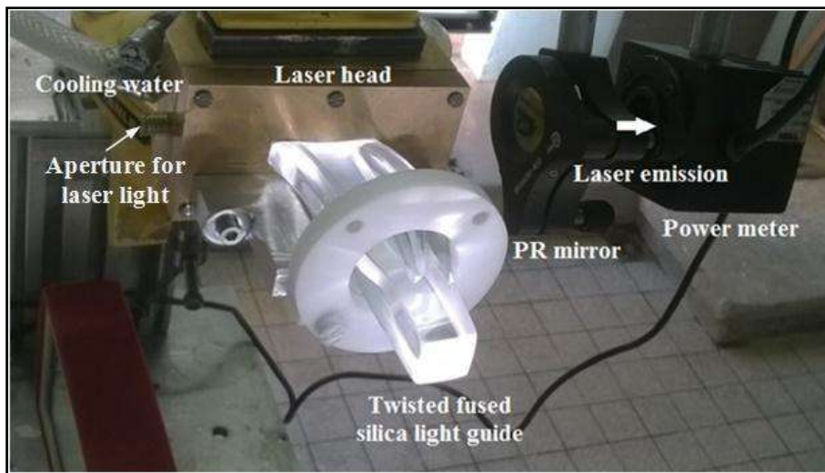
Fig. 4.33 : Tête laser composée du guide de lumière monolithique torsadé et du système mécanique
