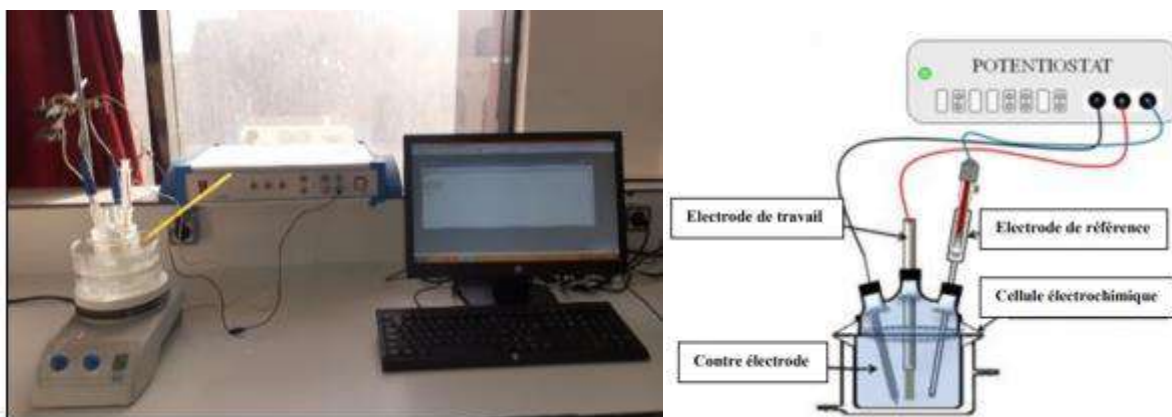
Figure II. 1 : Dispositif expérimental et cellule électrochimique à trois électrodes.
