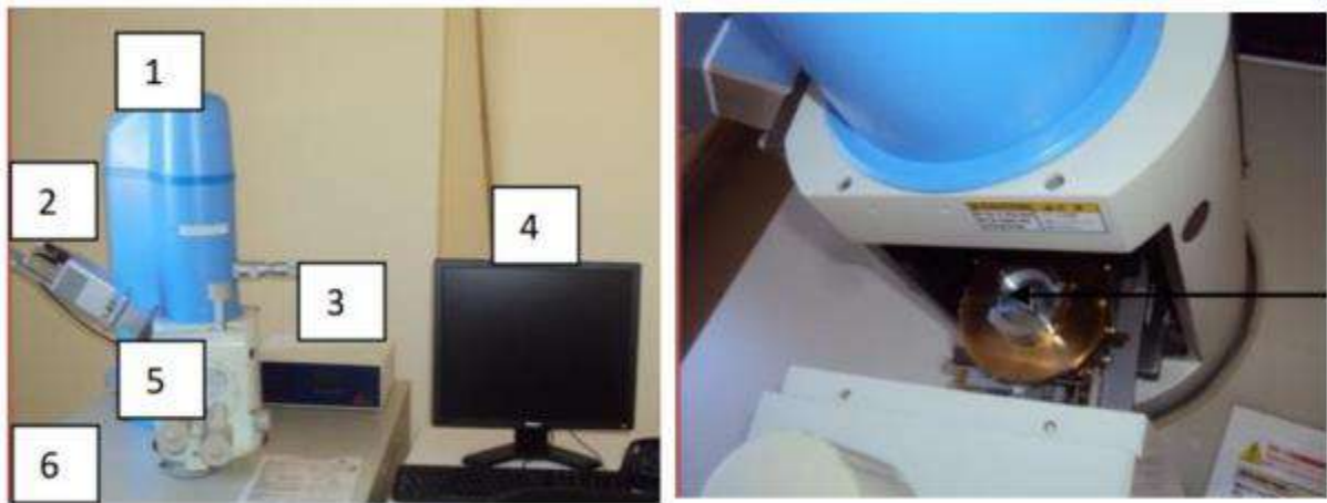
Figure II.6: Microscope électronique à balayage (MEB). Avec 1: Canon à électrons, 2 : Spectromètre de rayons X (EDS), 3: Instrument de commande, 4:Ecran de contrôle, 5: Commande de positionnement du spécimen, 6: Bâti de la pompe à vide.
