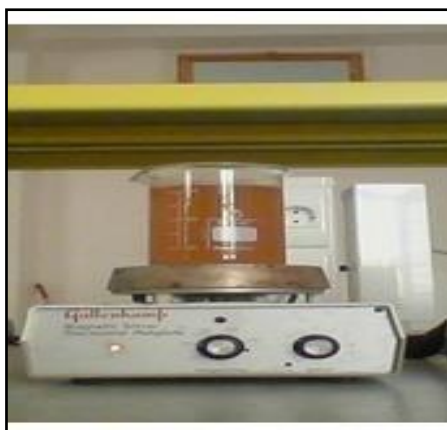
Figure (III-8) : Montage expérimental utilisé dans cas de Réactif du Fenton
