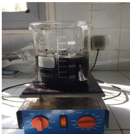
Figure (III-9) : Montage expérimental utilisé dans cas d'adsorption sur charbon actif.
