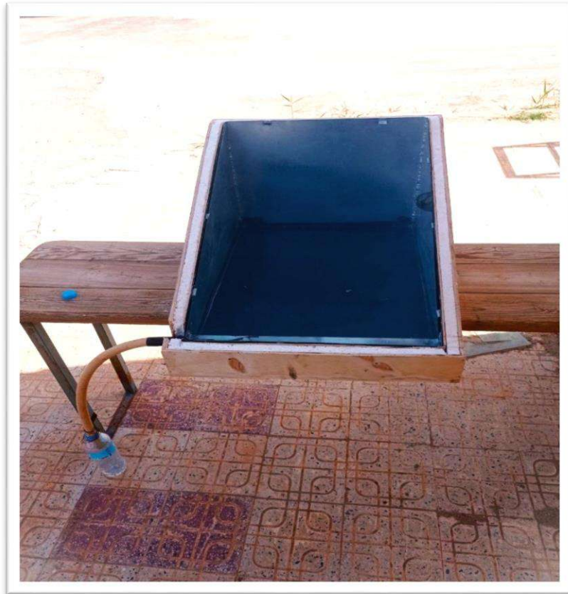
Figure III.3: Conception du distillateur solaire utilisé dans les expériences
