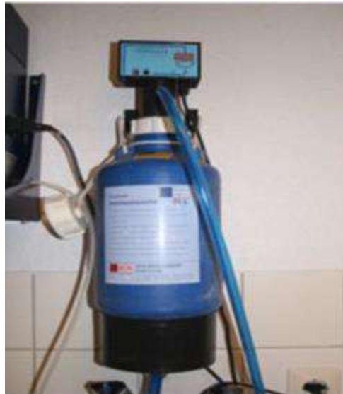
Figure.I.2 : Système d'échangeur d'ions. (FNDA ,2002)
