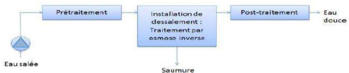
Figure II.3 : Schéma simple du procédé d'osmose inverse (Amitouche, 2016).
