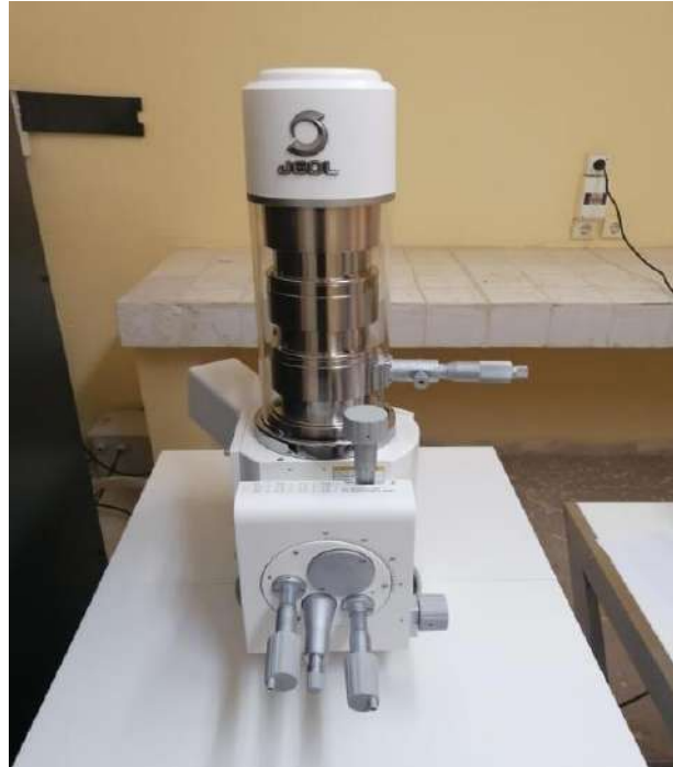
Figure II.8 : Microscope électronique à balayage [2].
