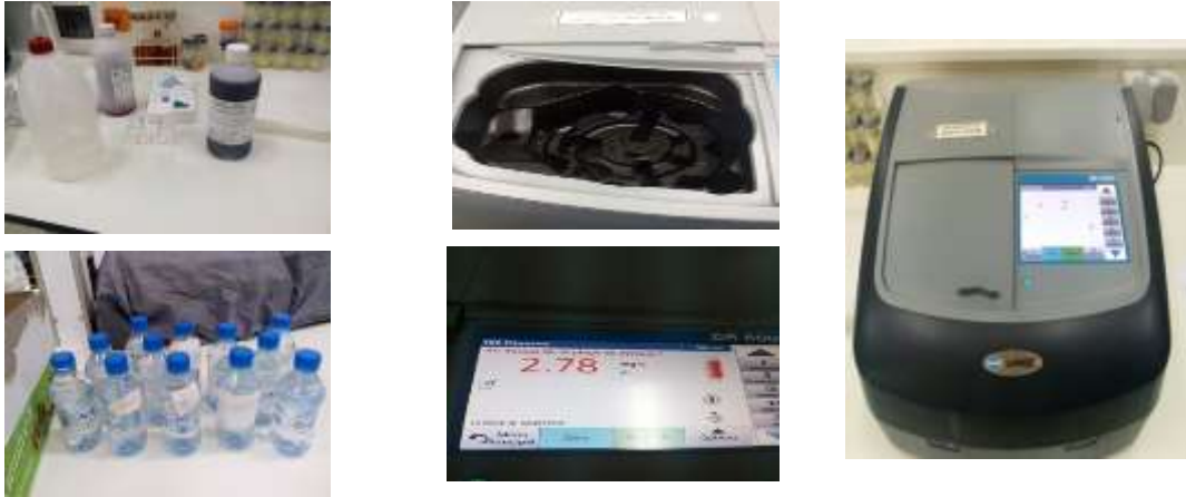
شكل 11.3. جهاز معايرة تركيز الفلوريد في مياه الابار
