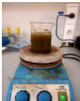
B/Agité a vitesse 350rpm Pendant 40min
