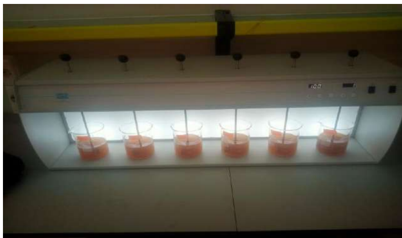
Figure 22: Méthode de jar test pour le coagulant naturel (Aloe Vera)
