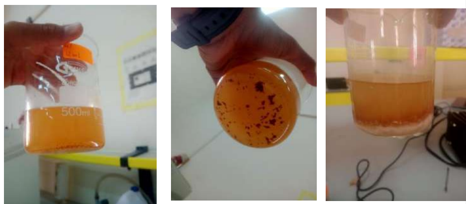
Figure 23: Divers échantillons après le traitement par le bio-coagulant (Aloe vera)
