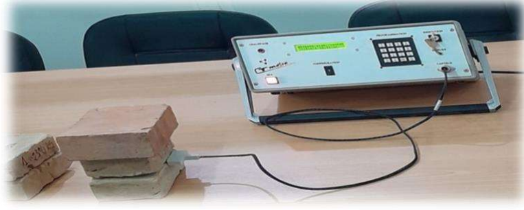
الشكل III-1 مبدأ القياس باستخدام السلك الساخن [24][25]
