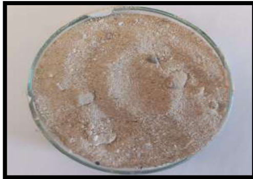
Photo (I.9) : Le Plâtre Traditionnel (Timchemt)
