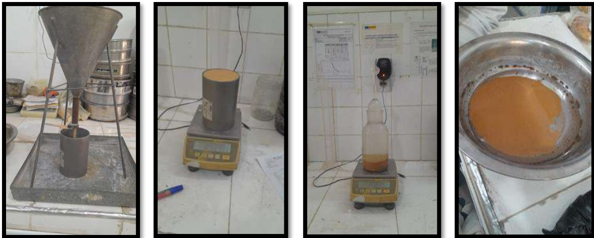
Photo (II.3): Essai De La Masse Volumique Apparente Et Absolue
