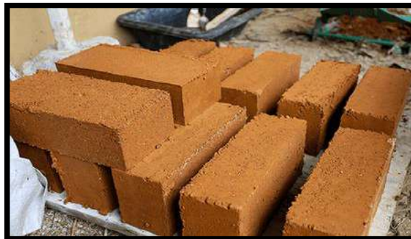
Photo (I.2) : Bloc De Terre Comprimée
