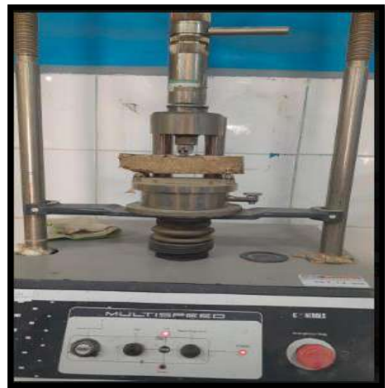
Photo (III.6) : L'essai De Résistance A La Flexion (3 Points)
