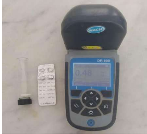
صورة V8 لجهاز قياس الكلور مع الكاشف اللوني المستخدم
