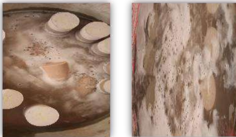
Figure III-6 : L'immersion des éprouvettes dans l'eau après 28 jour de conservation
