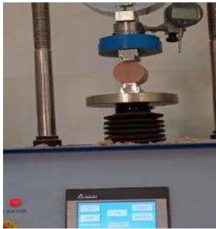
Figure III.7 : Éprouvette de traction pendant l'écrasement
