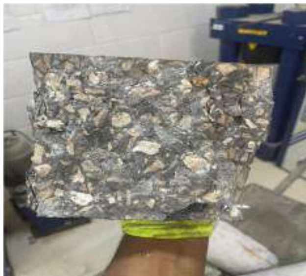
Photo IV.2 : Éprouvette humide après l'écrasement
