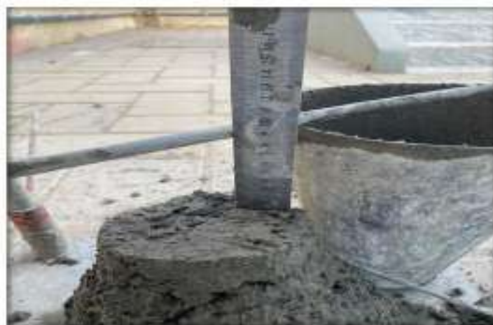
PhotoIII.6 : mesure de l'affaissement.
