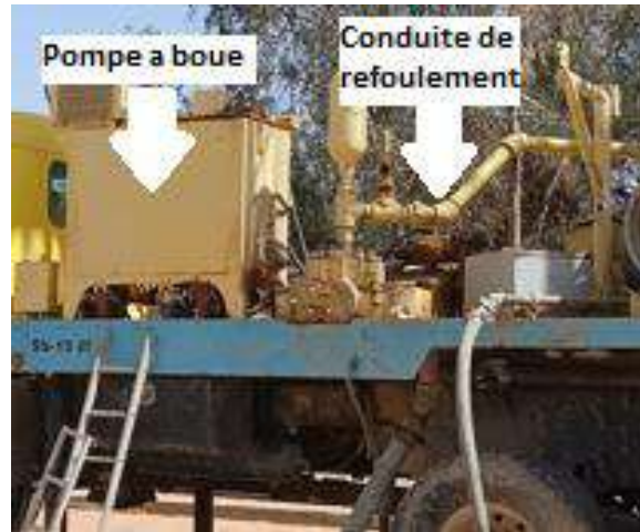
Figure II.09 : La conduite de refoulement
