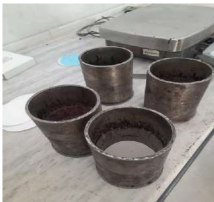
Figure IV.4. Les moules Marshall
