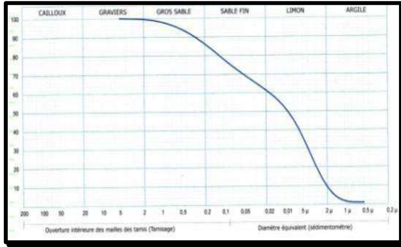
الشكل [6-1]: يوضح مخطط نتائج التدرج الحبيبي الترسبي. [1]
