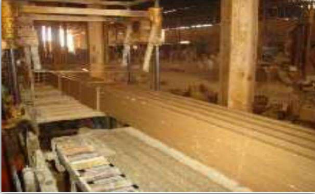
الشكل [3-1]: الشكل يوضح تشكيل الطوب الطيني. [1]
