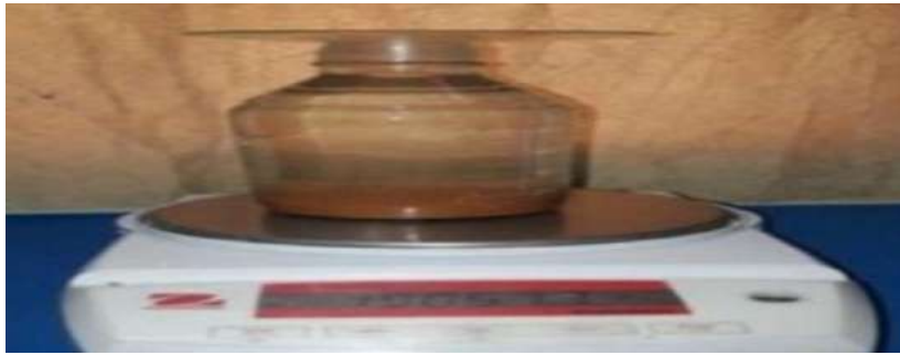
الصورة [5-1]: توضيح جهاز الكتلة الحجمية الظاهرية. [1]
