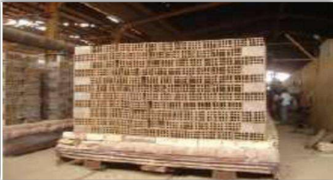
الشكل [4-1]: الشكل يوضح تجفيف المنتجات المشكولة. [1]
