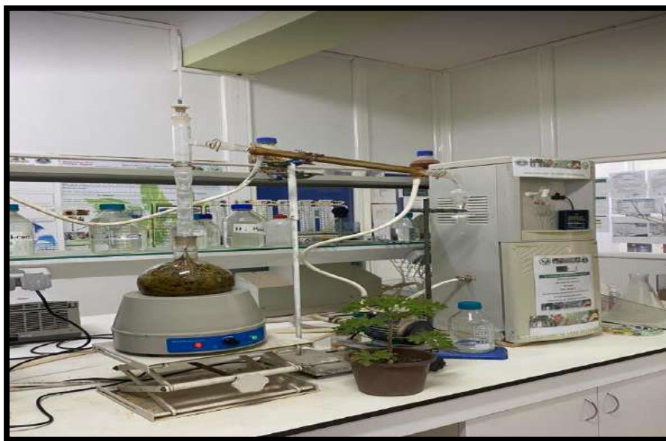
Figure 13 : Dispositif expérimental d'hydro distillation.
