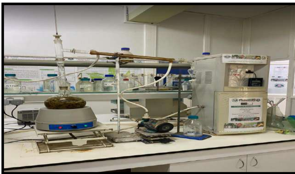
Figure 11 : Montage d'extraction par Hydro distillation[ 26]
