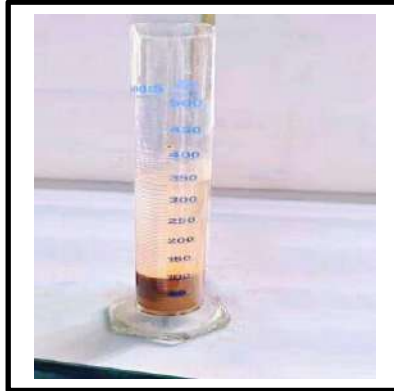
الصورة II.11 تجربة الكتلة الحجمية المطلقة بمسحوق الطوب (0.08/0)
