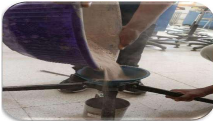
الصورة 3.II تجربة الكتلة الظاهرية
