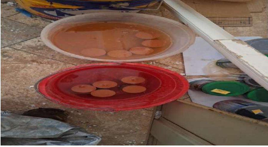
الصورة III.3 عينات الضغط للمخاليط بعد 28 يوما + 04 أيام من الغمر في الماء
