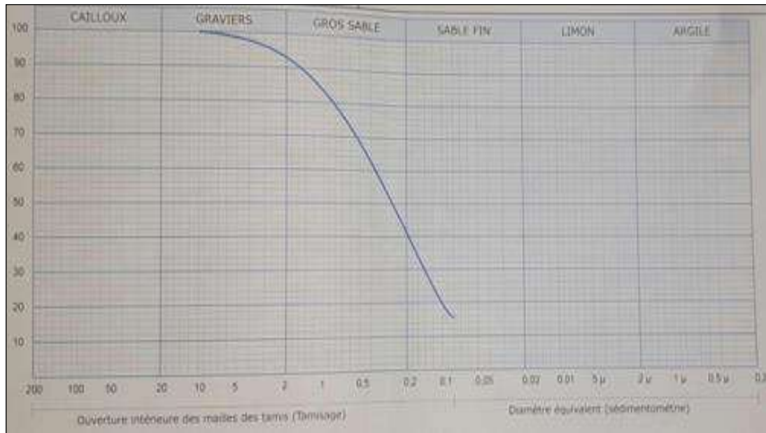
الشكل II.1 منحنى الحجم الحبيبي للتوف
