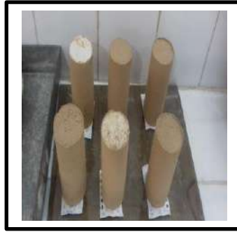
الصورة II 7. تجربة إختبار الضغط البسيط
