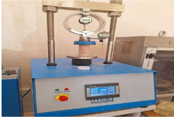
الصورة 2.III عينة اختبار الضغط أثناء التكسير
