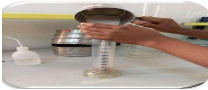
الصورة II.4 تجربة الكتلة الحجمية المطلقة
