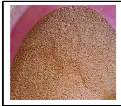
الصورة II.12 تجربة الكتلة الحجمية المطلقة بمسحوق الطوب (2.5/0.315)
