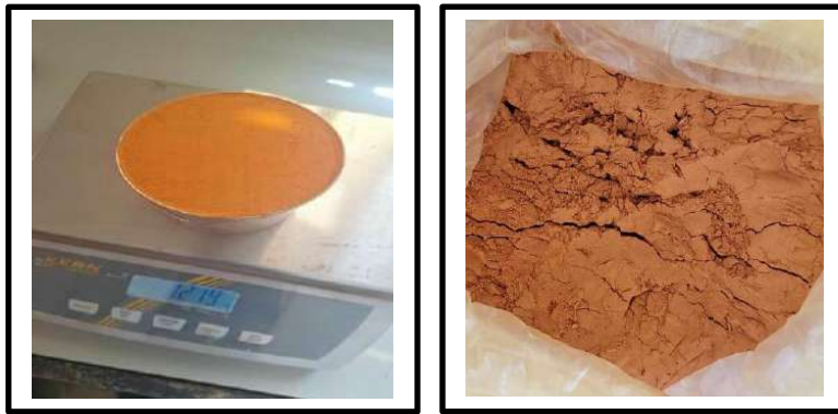
الصورة II.9 تجربة الكتلة الحجمية الظاهرية بمسحوق الطوب (0.08 /0)
