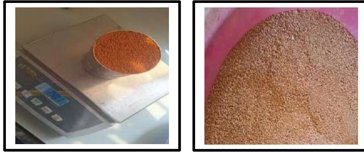
الصورة 10. II تجربة الكتلة الحجمية الظاهرية بمخلفات حصى الطوب (2.5/0.315)
