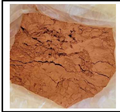
الصورة II.11 تجربة الكتلة الحجمية المطلقة بمسحوق الطوب (0.08/0)
