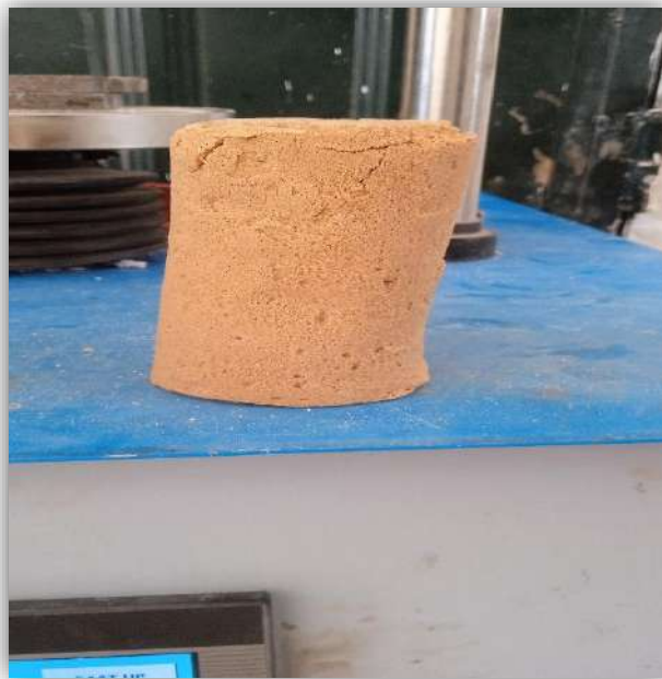
Figure III.9 : L'échantillon après l'essai de compression
