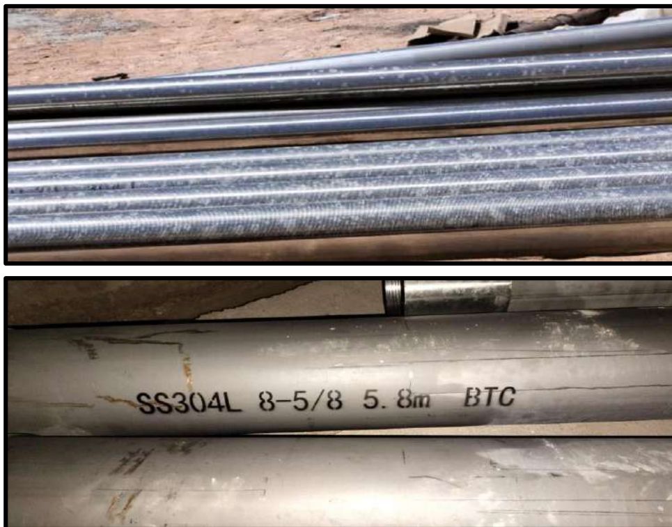
Figure II.12 : Tube pleins et Crépines
