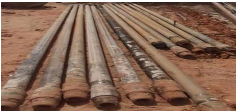
Figure II.4: Les Tiges Et Les Mass Tiges
