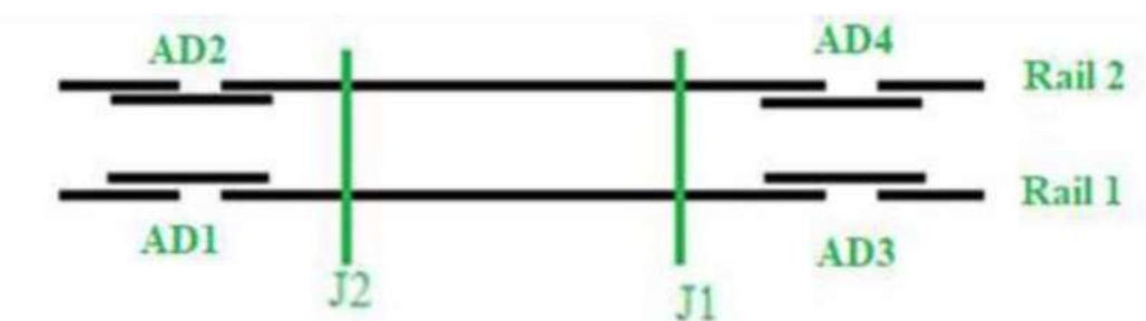
Figure 2-2 : Positionnement des appareils de dilatation sur le pont.
