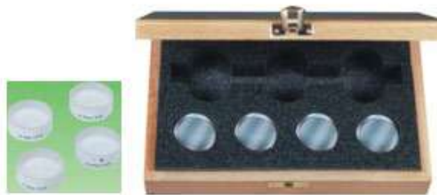
Figure IV.6 Boîte de verres plans parallèles pour contrôle de planéité et du parallélisme des faces de mesure
