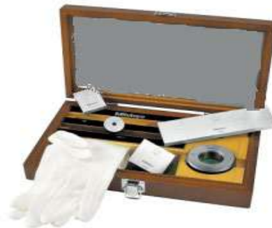
Figure IV.1 Boîte de cales étalons et de bague étalons
