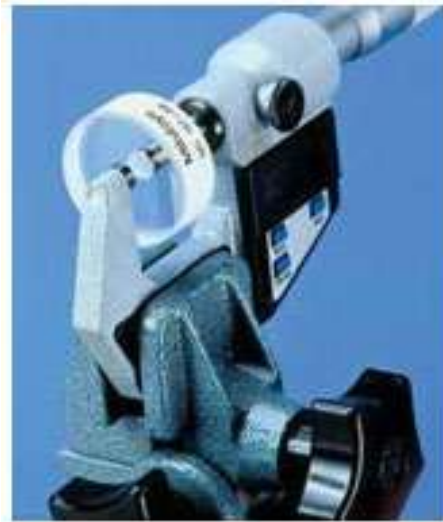
Figure IV.9 Positionnement du verre plan parallèle entre les deux faces de mesure
