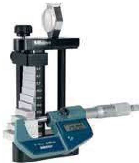
Figure IV.10 Positionnement des cales étalons dans leur support
