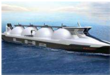
Fig.1.11: Kawasaki conception de l'industrie lourde pour les transporteurs d'hydrogène liquide
