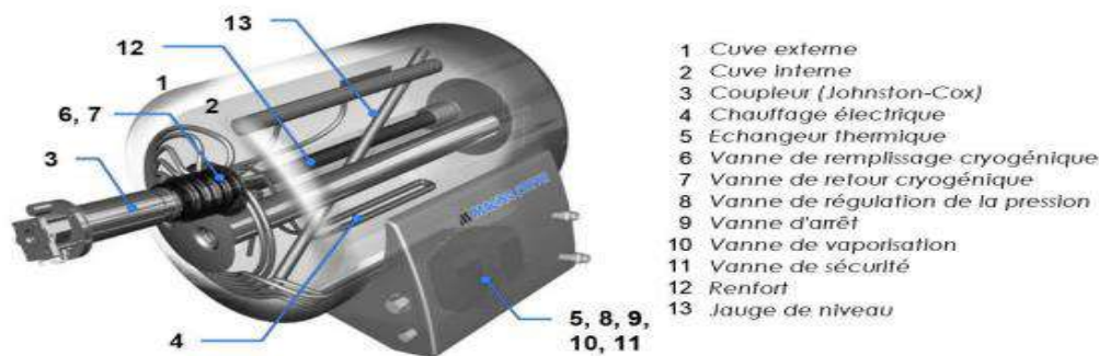
Fig.1.8 : Réservoir cryogénique (ou cryostat) développé par Magna Steyr
