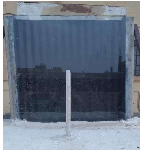
Figure II. 3 : Cheminée solaire avec absorbeur à surface ondulée
