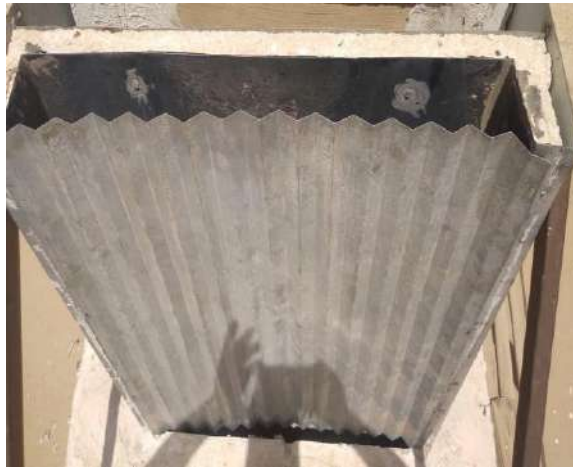
Figure II. 3 : Cheminée solaire avec absorbeur à surface ondulée
