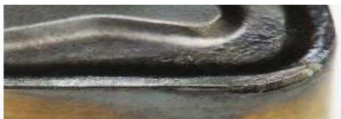
Figure I.11: Usure en dépouille [9]
