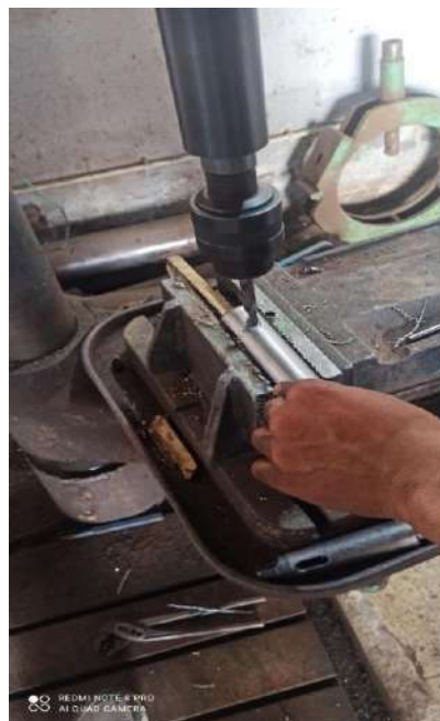
Figure II.13. Création d'un trou pour la fixation
