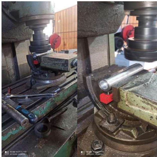
Figure II.11. Opération de surfaçage sur la fraiseuse
