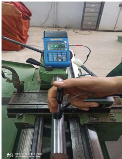
Figure III.5. Méthode de mesure de la micro dureté
