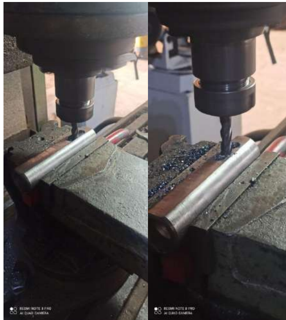
Figure II.12. Opération de rainurage
