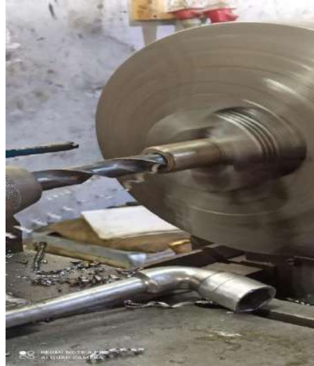
Figure II. 10. Opération de perçage
