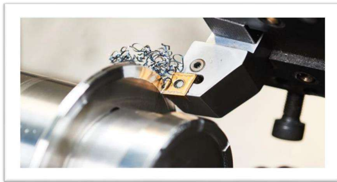
Figure I.2 : Enlèvement de matière par tournage [4]
