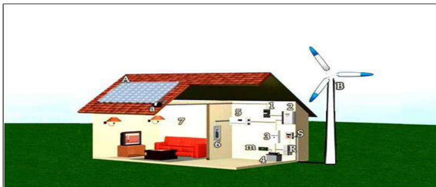
Figure.II.1: Système d'énergie hybride photovoltaïque-éolien.
