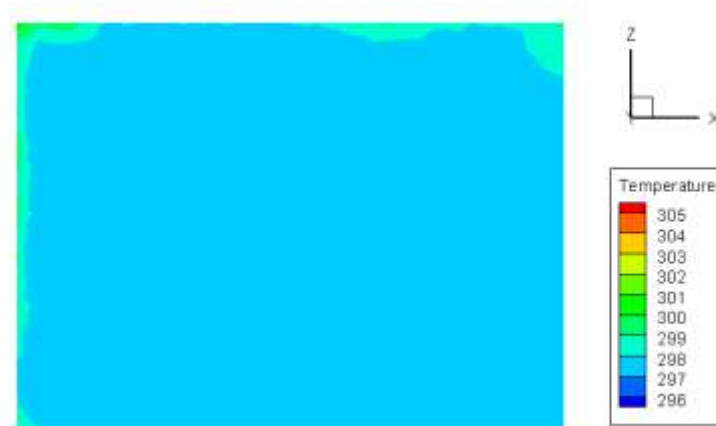
Figure 3-23 Contours de température dans le plan horizontal du local proposé, avec ventilateur.
