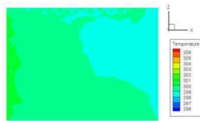
Figure 3-16 Contours de température dans le plan horizontal du local proposé.
