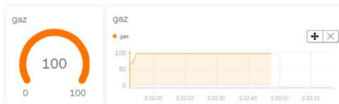
Figure II. 41 : Lecture du capteur de gaz Avant d'ouvrir le ventilateur et la fenêtre.
