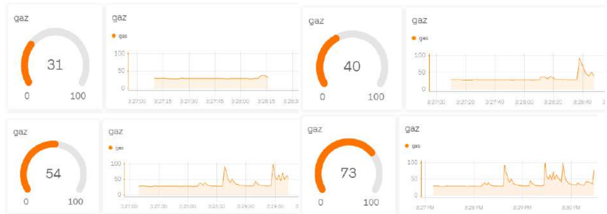
Figure II. 40 : Lecture du capteur de gaz à différentes concentrations.
