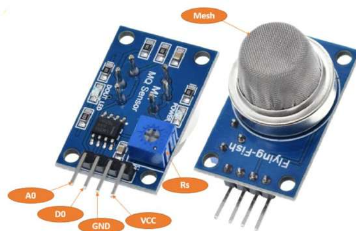
Figure I. 3 : Les broches du capteur gaz MQ2.
