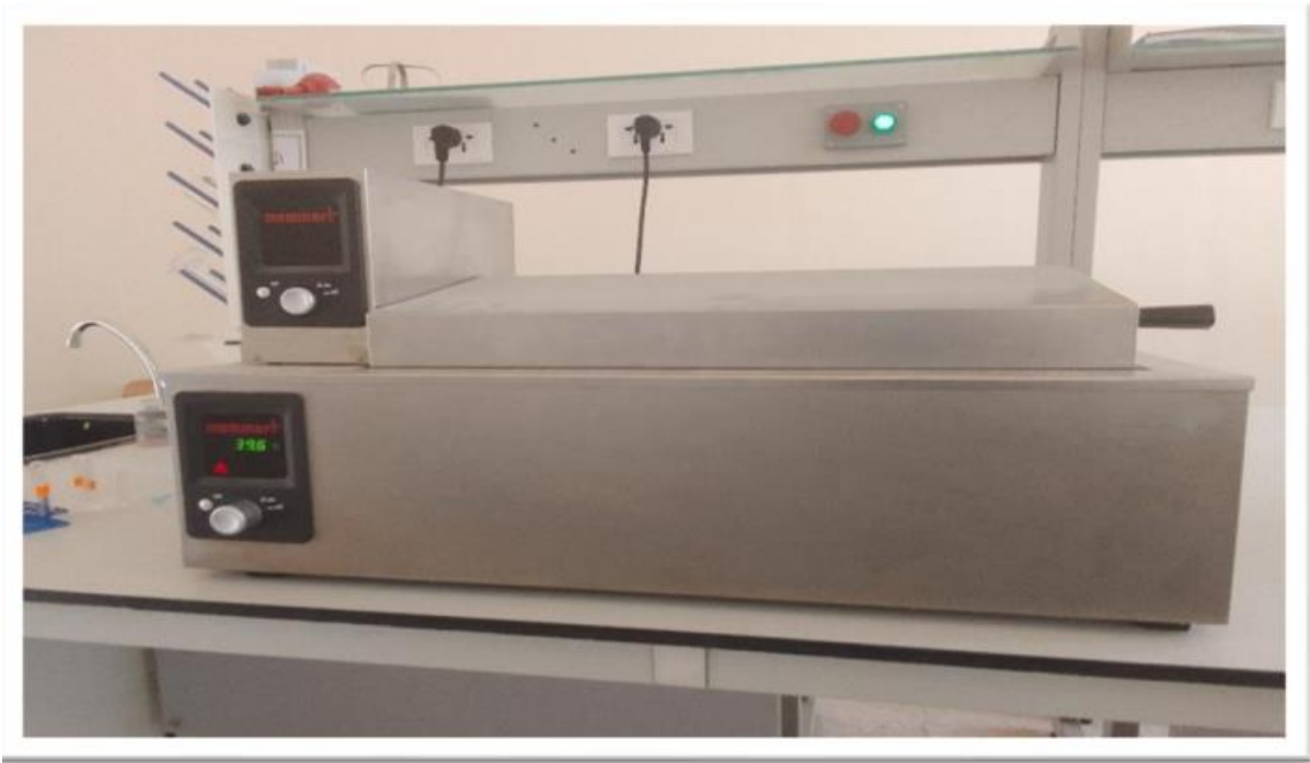
Figure II.11: Image d'un agitateur rotatif utilisé pour les expériences d'adsorption de colorant et de modification de l'argile
