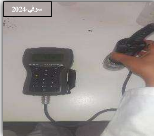
الشكل (4) : صورة جهاز متعدد القياسات (Multiparameter ;HANNA,HI9829)
