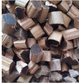
الشكل 2.VII عصيات جريد نخيل التمر على شكل حصى (GDPR).
