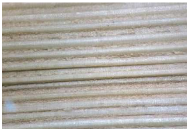
الشكل 2.IV مقطع طولي بالمجهر الضوئي لعصيات جريد النخيل.
