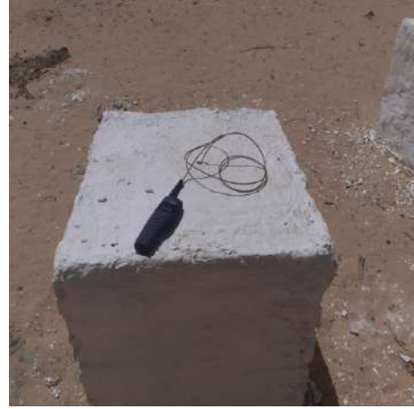
قياس الحرارة الداخلية للمجسمات الجبسية
