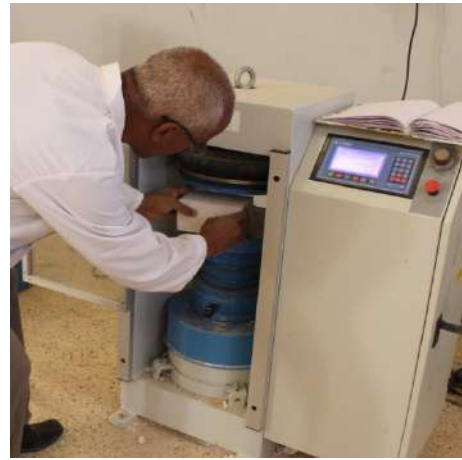
تجربة الانحناء بثلاث نقاط لعصيات جريد النخيل
