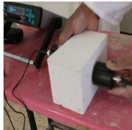
قياس سرعة الأمواج فوق الصوتية للعينات
