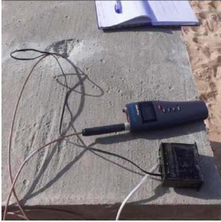
قياس الحرارة الداخلية للمجسم الاسمнти
