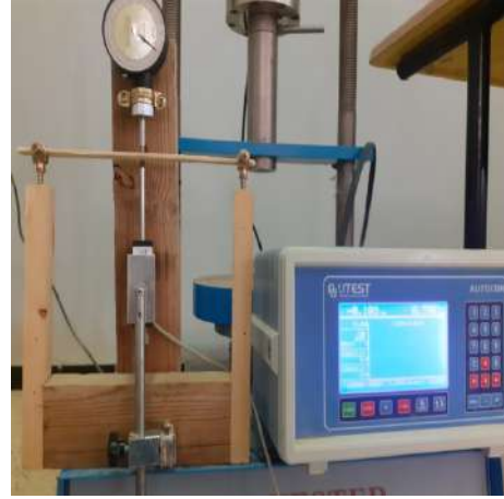
تجربة الانحناء بثلاث نقاط لعصيات جريد النخيل
