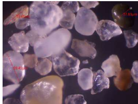
الشكل 8.IV صورة بالمجهر الضوئي لرمل الكثبان المستعمل.
