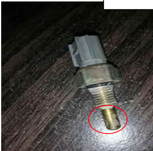
الشكل II. 6: تشوه حساس درجة الحرارة.
