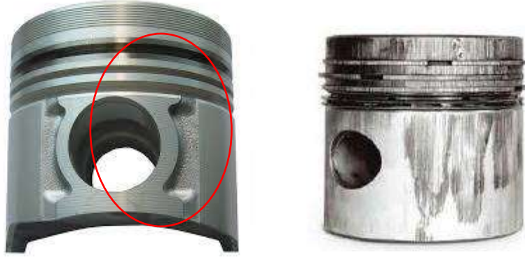
الشكل II. 3: تشوه المكبس.
