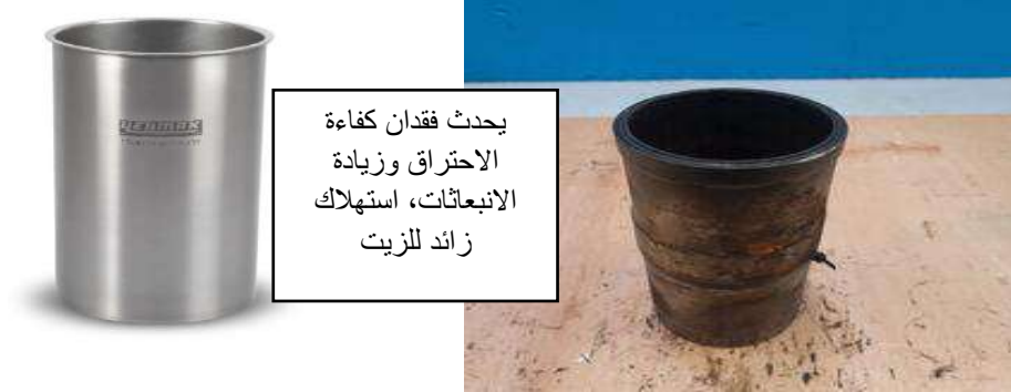
الشكل II. 15: تلف بطانة الاسطوانة.
