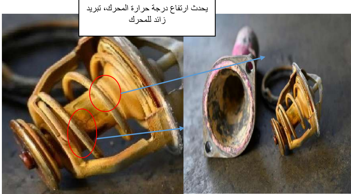
الشكل II. 13: تلف منظم الحرارة.
