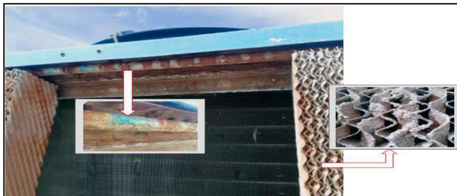
Figure II.18 : Dépôts minéraux sur tuyau de distribution d'eau et panneau évaporatif
