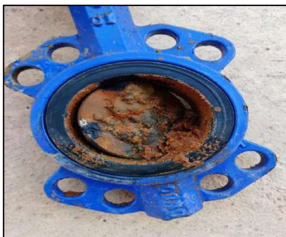
Figure II.8 : Vanne papillon DN 80 grippé à cause sable
