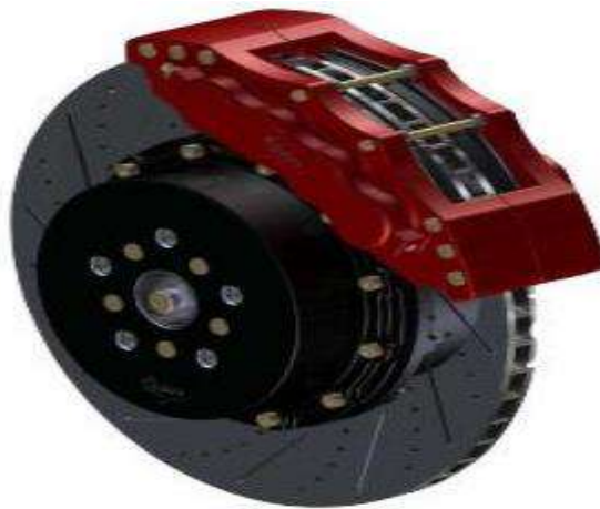
Figure I.5 – Illustration d'un frein à disque [9].
