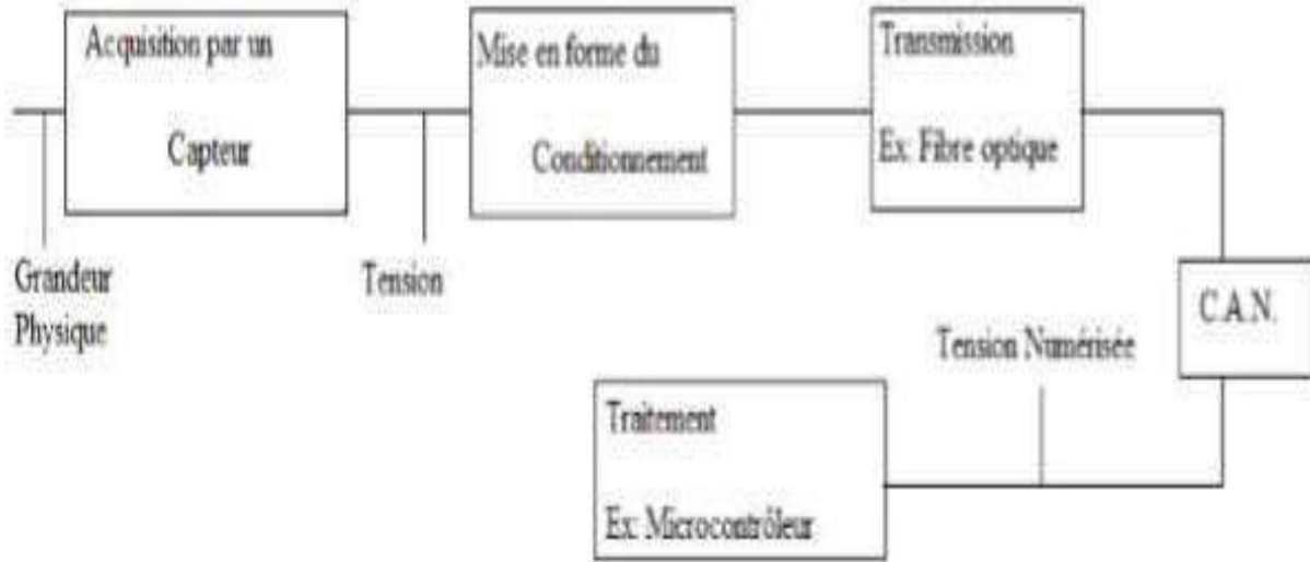
Figure II-21 : Schème de fonctionnement d'un capteur
