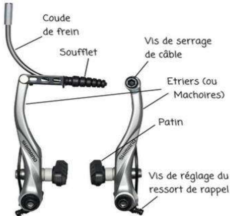
Figure I-15 composants d'un frein de vélo [11].
