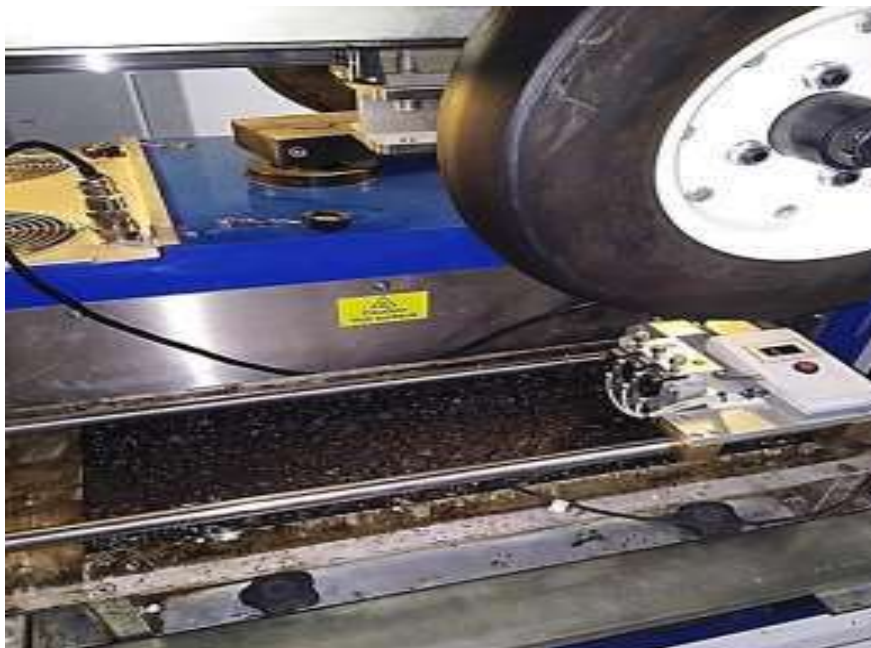
Figure IV. 17 : Mesure de la profondeur d'orniérage
