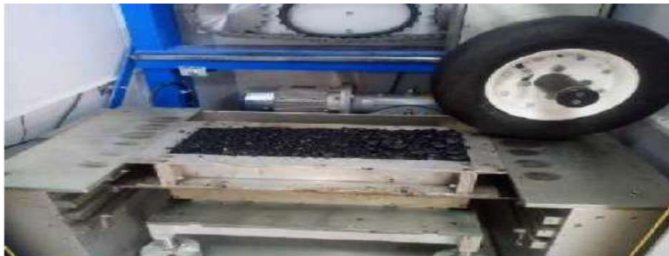
Figure II.3 : Préparation de plaque sur la table de compactage.
