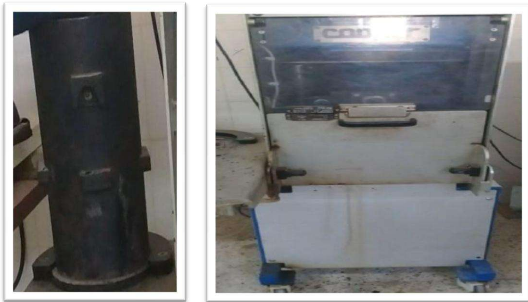
Figure IV. 21 : Appareillage PCG : Moule d'éprouvette (a) et Machine de PCG (b)
