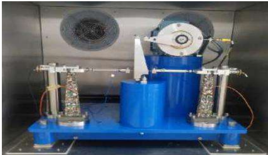
Figure II.7 : Essai de flexion 2 points sur éprouvette trapézoïdale.
