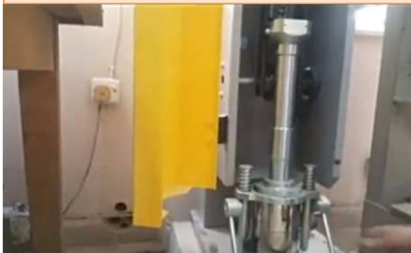
Compactage par impact
